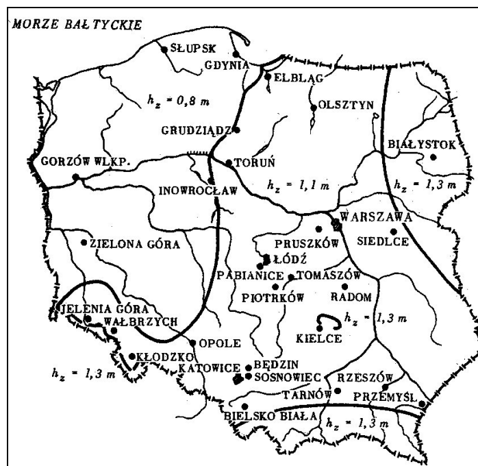
Ryc. 5.2. Mapa Polski z zaznaczonymi strefami głębokości przemarzania gruntów z normy PN-59/03020
