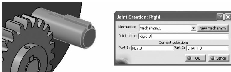
RYSUNEK 10.18. Okno dialogowe Joint Creation: Rigid (tworzenie więzu sztywnego)
