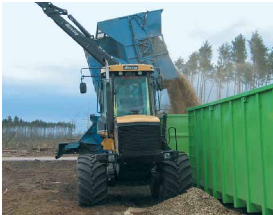
Rycina 7. Zrzut zrębków do kontenera przy drodze wywozowej
