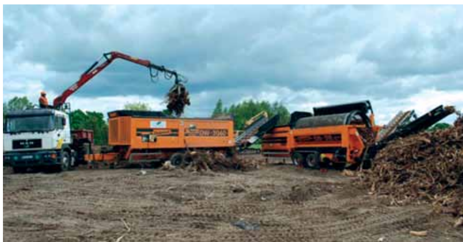
Rycina 9. Rozdrabniacz wolnoobrotowy Doppstadt DW 3080 wraz ze stacją przesiewającą
