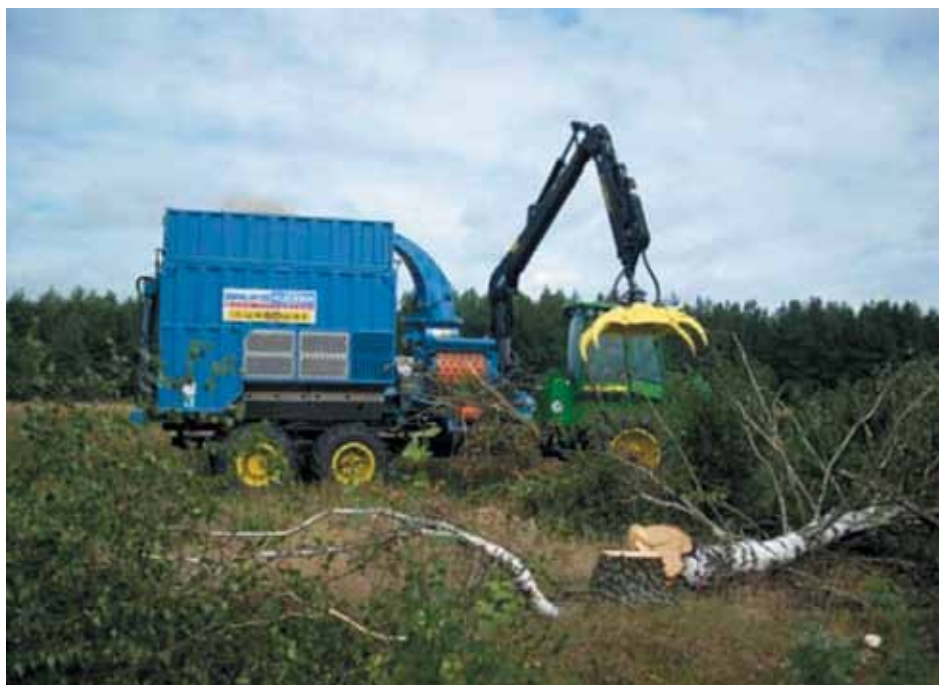
Rycina 4. Rębarka Bruks 805 CT na podwoziu forwardera John Deere 1410B
