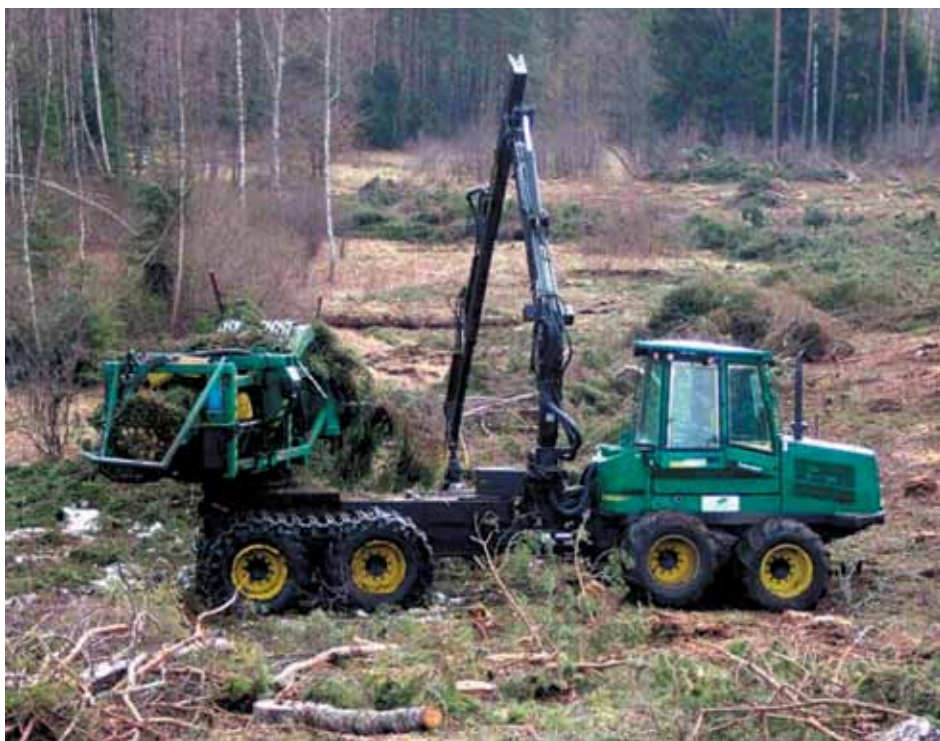
Rycina 6. Produkcja balotów na zrębie zupełnym
