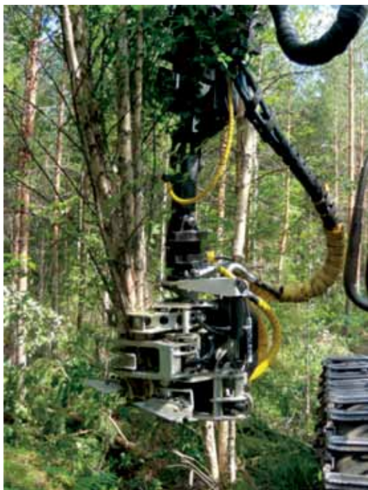
Rycina 2. Głowica pakietująca MOIPU 230 zamontowana na żurawiu forwardera
