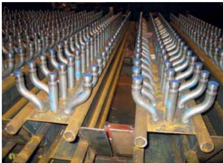
Rycina 2. Dno komory paleniskowej Hydro Beam
