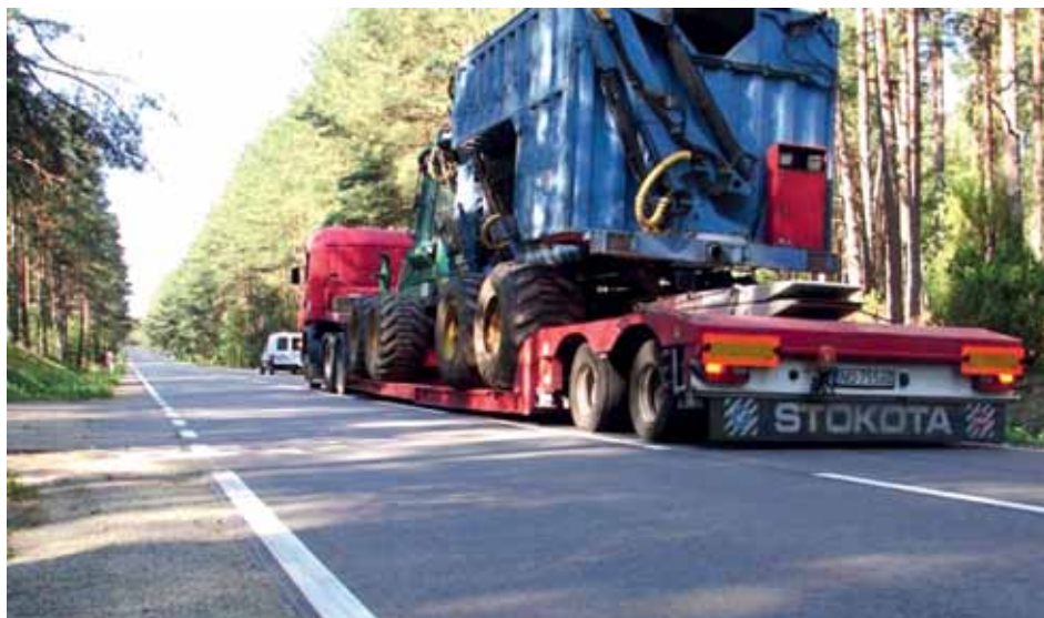
Rycina 15. Transport rębarki samobieżnej zestawie niskopodwoziowym
