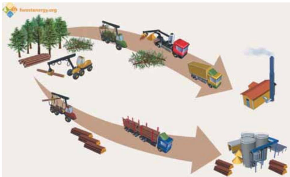
Rycina 5. Zintegrowane pozyskanie drewna okrągłego i zrębków energetycznych z pozostałości pozrębowych
