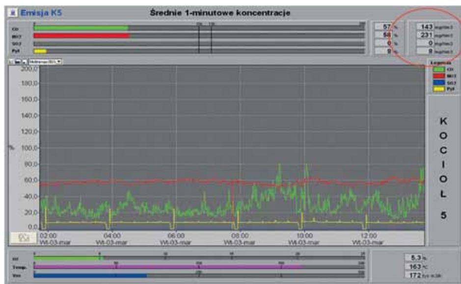
Rycina 3. Monitoring emisji kotła OFB-105
