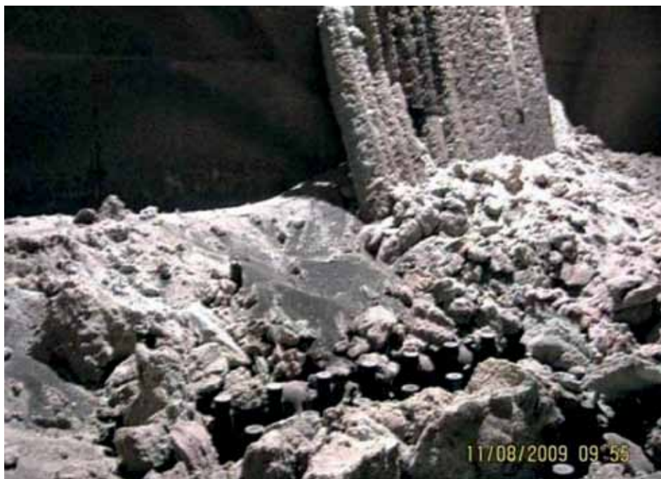
Rycina 5. Aglomeracja złoża w wyniku spalania biomasy agro o podwyższonej zawartości związków alkalicznych
