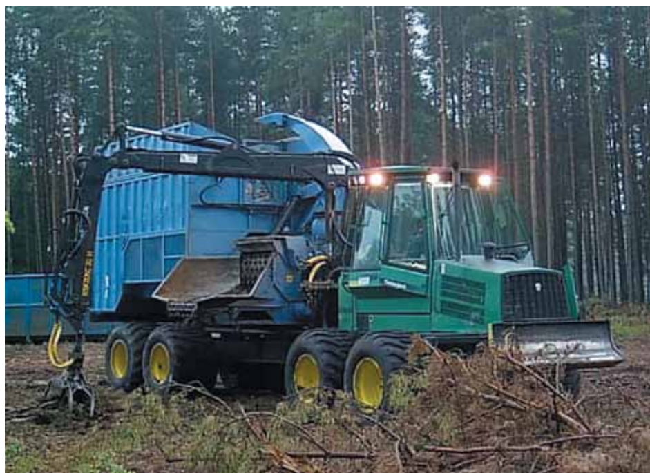
Rycina 5. Rębarka Bruks 804 CT na podwoziu forwardera Timberjack 1410 B
