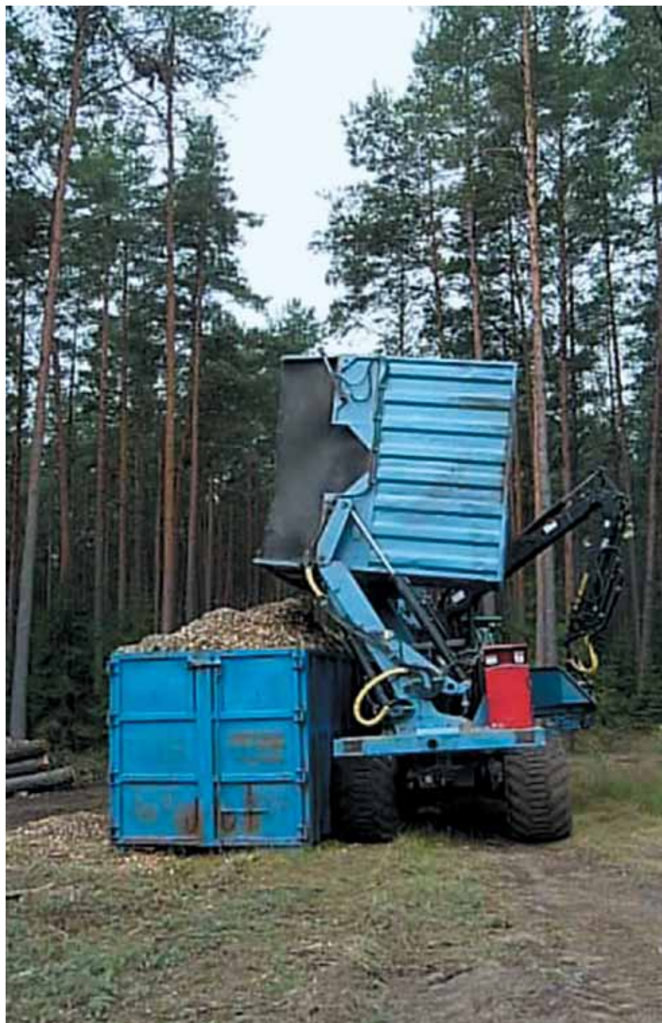
Rycina 6. Wyładunek zrębków z zasobnika rębarki do kontenera wywozowego
