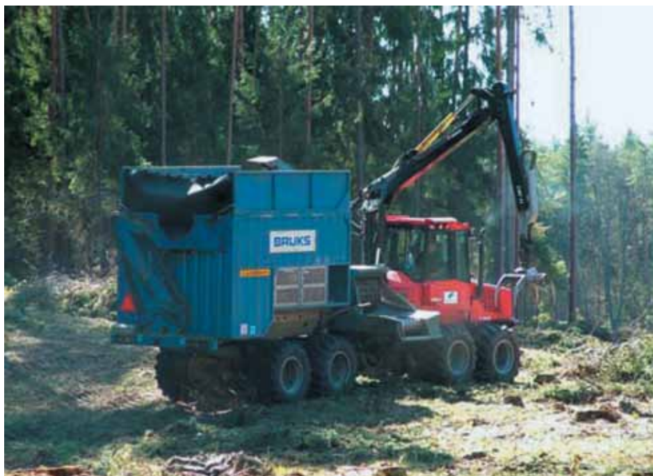
Rycina 3. Rębarka Bruks 805.2 STC na podwoziu forwardera Valmet 860.4
